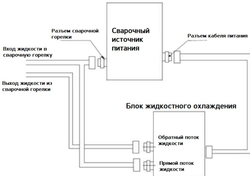
1. Перед включением блока жидкостного охлаждения необходимо залить жидкость в резервуар.
